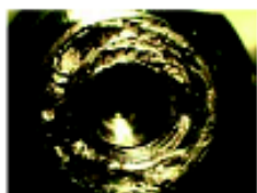
Pâte au cuivre standard. Arrachement du métal très visible = GALLING
